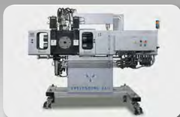
Фильтрозаменитель с обратной промывкой: филь-трация расплава, особенно при использовании переработанного материала
