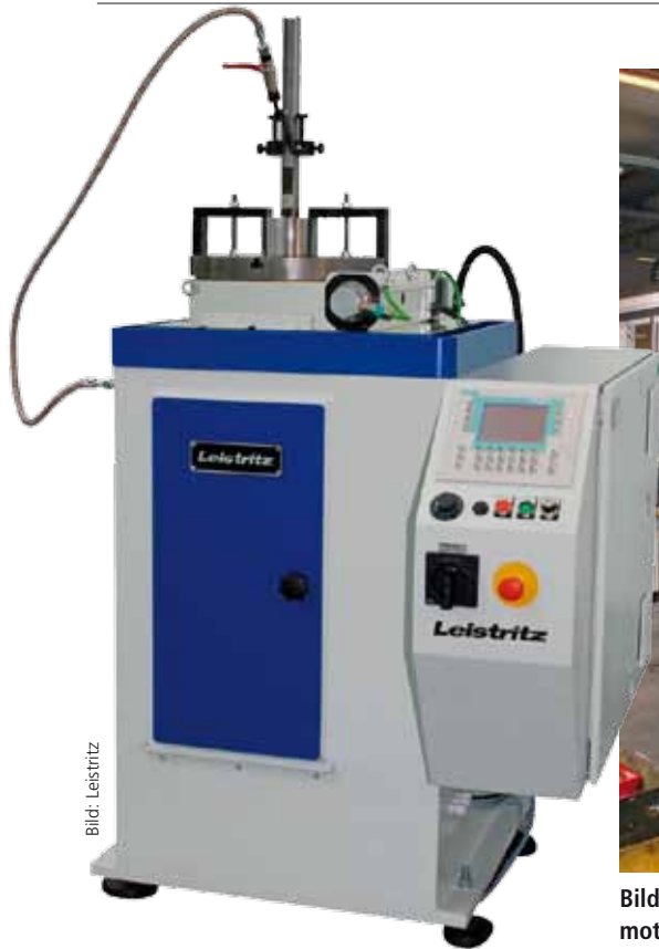
Bild 1: Die Nutzenziehmaschine braucht weniger als 2 m 2 Platz und sorgt für deutlich präzisere Nuten als das bisherige Räumverfahren.
