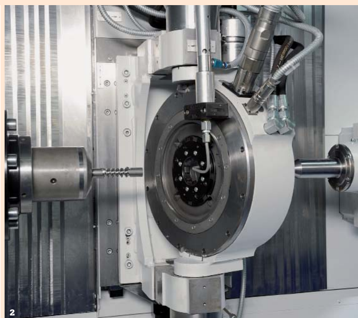
2 Das Herzstück der Wirbelmaschine ist der Hightech-Antrieb im Wirbelaggregat.
