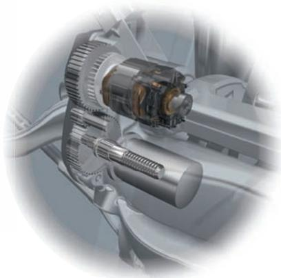
elektrische Feststellbremse [5]
