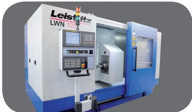
Innenwirbelmaschine LWN 120 IW
