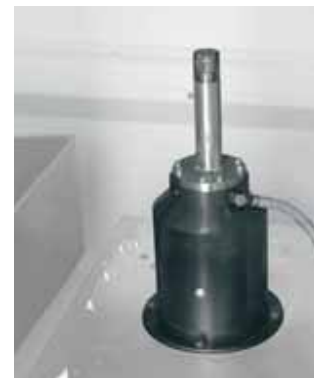
Der Innenwirbel-Oszillator IWO 100, thermisch stabilisiert
