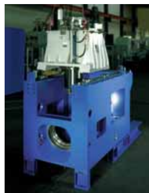
Schwingungsgedämpfter Grundkörper aus hochwertigem Polymerbeton Mineralit®
