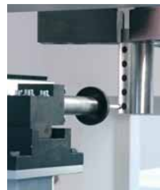
In die Maschine integriertes Messsystem
