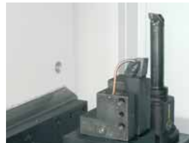
Blockstahlhalter zur Aufnahme von 2 Drehwerkzeugen
