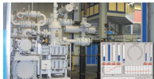
Испытательный стенд мультифазных насосов Leistritz
