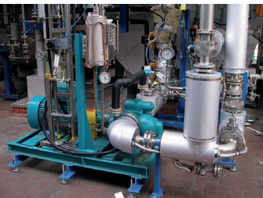
Die Pumpe eignet sich für einen breiten Viskositätsbereich von 1 bis 30 000 mPas
