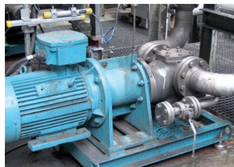
Pompa blendingu typu L2NG Leistritz w produkcji farb wodnych
