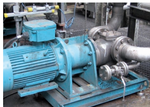
смесительный насос для производства краски на водной основе Leistritz L2NG
