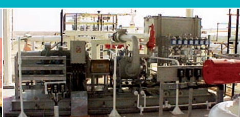
Мультифазный насос Leistritz на нефтяном месторождении на Аравийском полуострове Q = 410 \text{ м}^3/\text{ч} \cdot \Delta p = 36 \text{ бар} \cdot GVF = 90 \%
