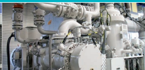
Мультифазный насос Leistritz для морской платформы в Абу-Даби Q = 113 \text{ м}^3/\text{ч} \cdot \Delta p = 31,03 \text{ бар} \cdot GVF = 77 \%
