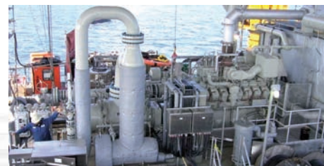
1 Многофазный насос L4НК на морской платформе
