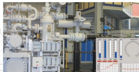
Испытательный стенд мультифазных насосов Leistritz
