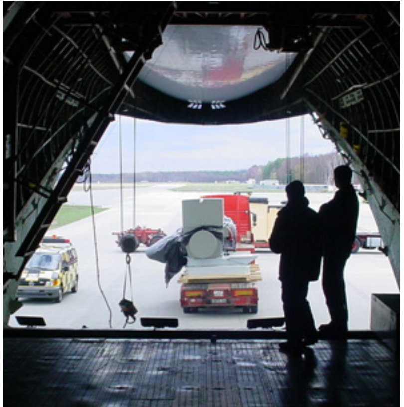
Mit Hilfe eines Kransystems wird die Fracht eingeladen. Bild: Leistritz
