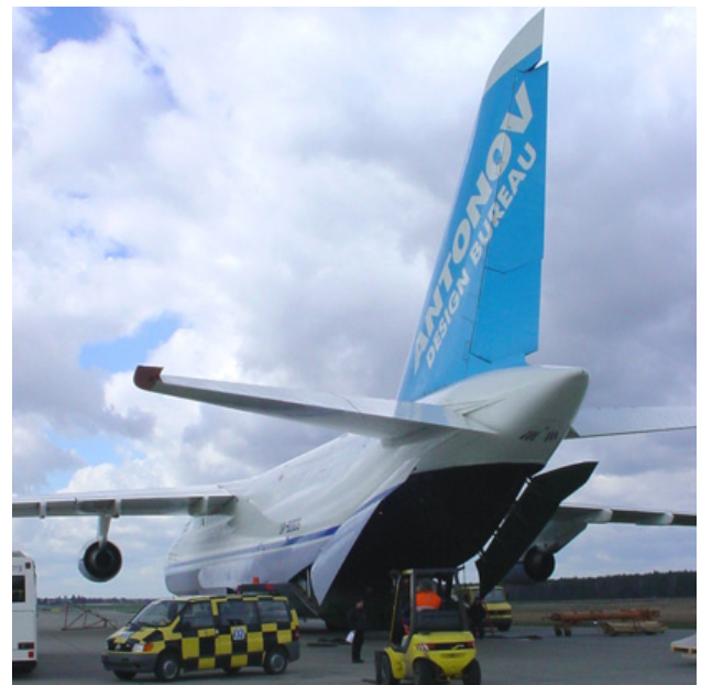
Gigantische Ausmaße: Die An-124 hat eine Spannweite von 73,4 Metern, ist über 69 Meter lang und fast 21 Meter hoch. In die Tanks passen 250 000 Liter Kerosin; pro Stunde werden bei 800 km/h 14 500 Liter verbraucht.
