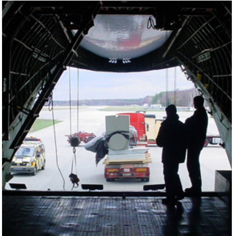
Blick aus dem 36 Meter langen, 6,40 Meter breiten und 4,40 Meter hohen Frachtraum der Antonow 124: Zum Laden steht der russischen Crew ein eigener 30-Tonnen-Kran zur Verfügung. Maximales Startgewicht: 405 Tonnen
