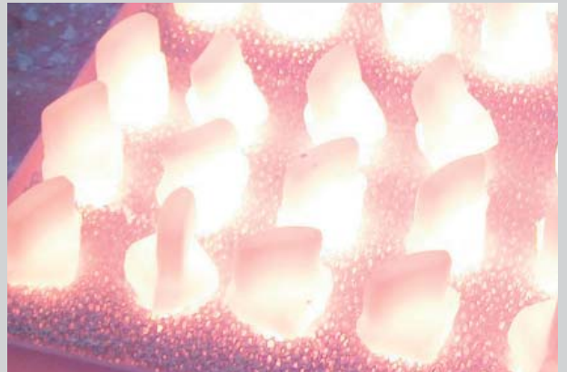
固溶退火中的压缩机TiAl叶片
