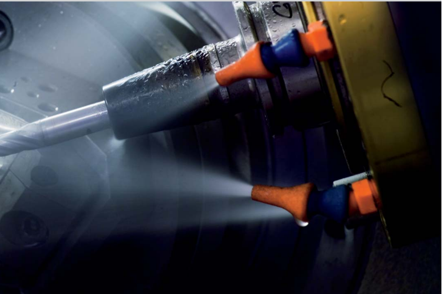
5-轴铣床铣削叶片组件的翼面
