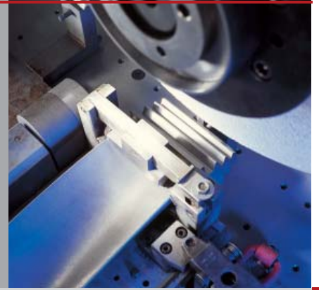
蠕动进给磨削树根状叶根
