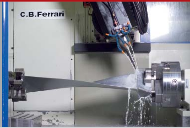
5-轴铣床铣削汽轮机叶片
