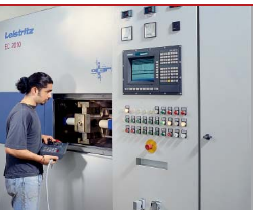
莱赛狮加工压缩机叶片的ECM机床
