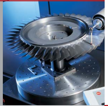
三坐标测微仪(CMM)测量叶片轮/带叶整体转子(Blisk/IBR)
