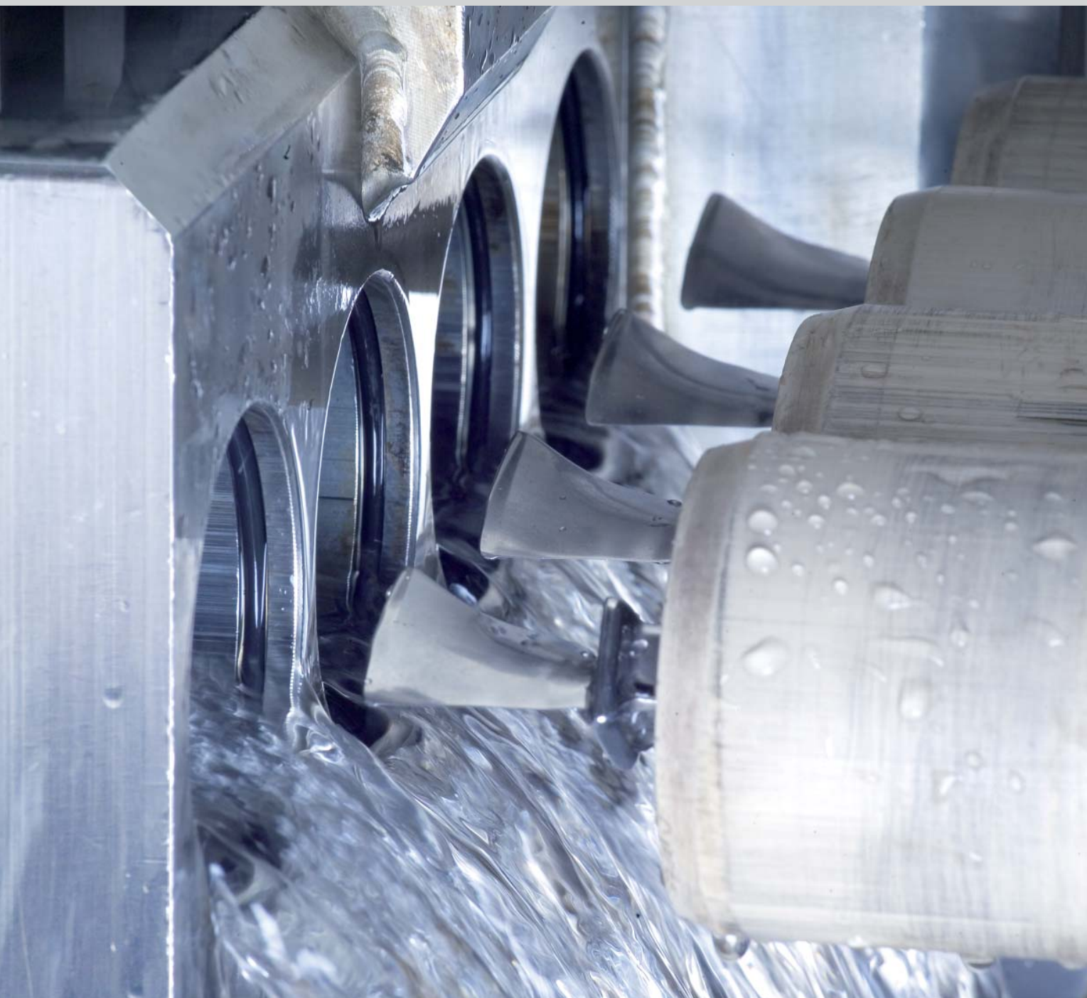
ECM方法加工压缩机翼面叶片的详情
